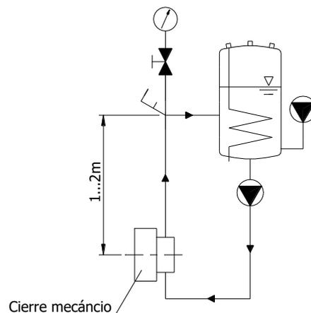
**Figura 4.6.1:** Esquema de instalación del depósito de presurización.
