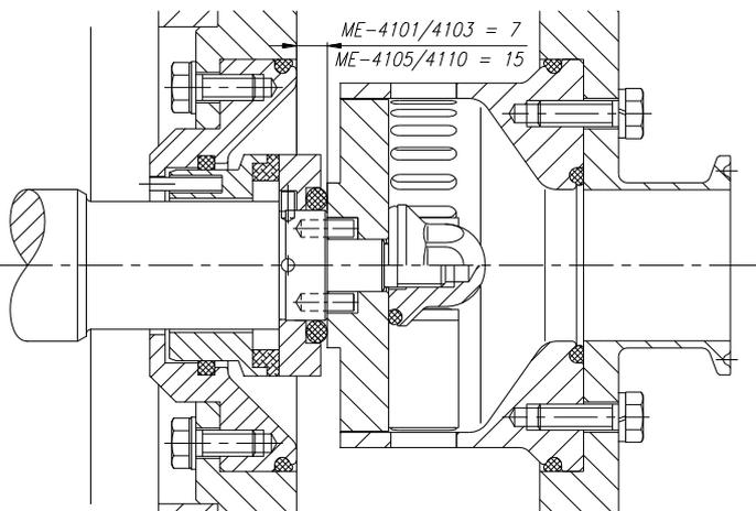
Deslizar la parte giratoria del cierre mecánico (08) a través del eje (05) encarando la ranura con el pivote hasta hacer tope en éste.
