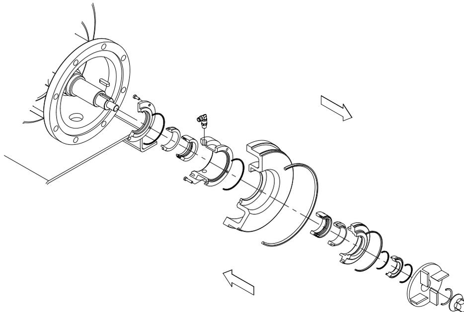
**¡ATENCIÓN! Al montar el nuevo cierre, tener precaución de montar las piezas y las juntas con agua jabonosa a fin de facilitar el deslizamiento de las mismas, tanto de la parte fija como de la parte giratoria sobre el eje.**
