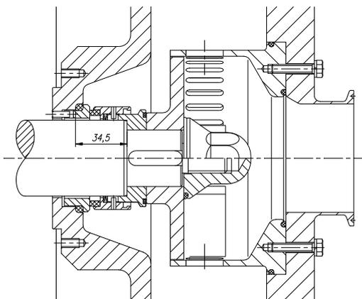
Colocar la junta (80) y la parte estacionaria del cierre (08) en la tapa (03) teniendo en cuenta el pivote.
