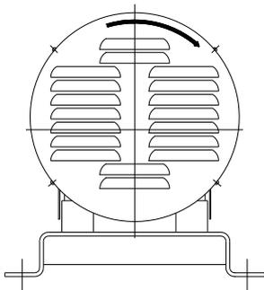
Poner en marcha el motor del Mixer momentáneamente. Asegurase, mirando el Mixer por detrás, que la dirección de rotación del ventilador del motor es en sentido horario.
