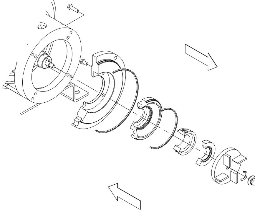
**¡ATENCIÓN! Al montar el nuevo cierre, tener precaución de montar las piezas y las juntas con agua jabonosa a fin de facilitar el deslizamiento de las mismas, tanto de la parte fija como de la parte giratoria sobre el eje.**
